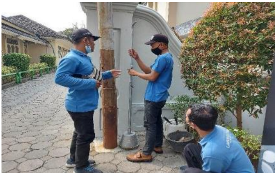
Pemasangan alat uji kualitas udara passive sampler
